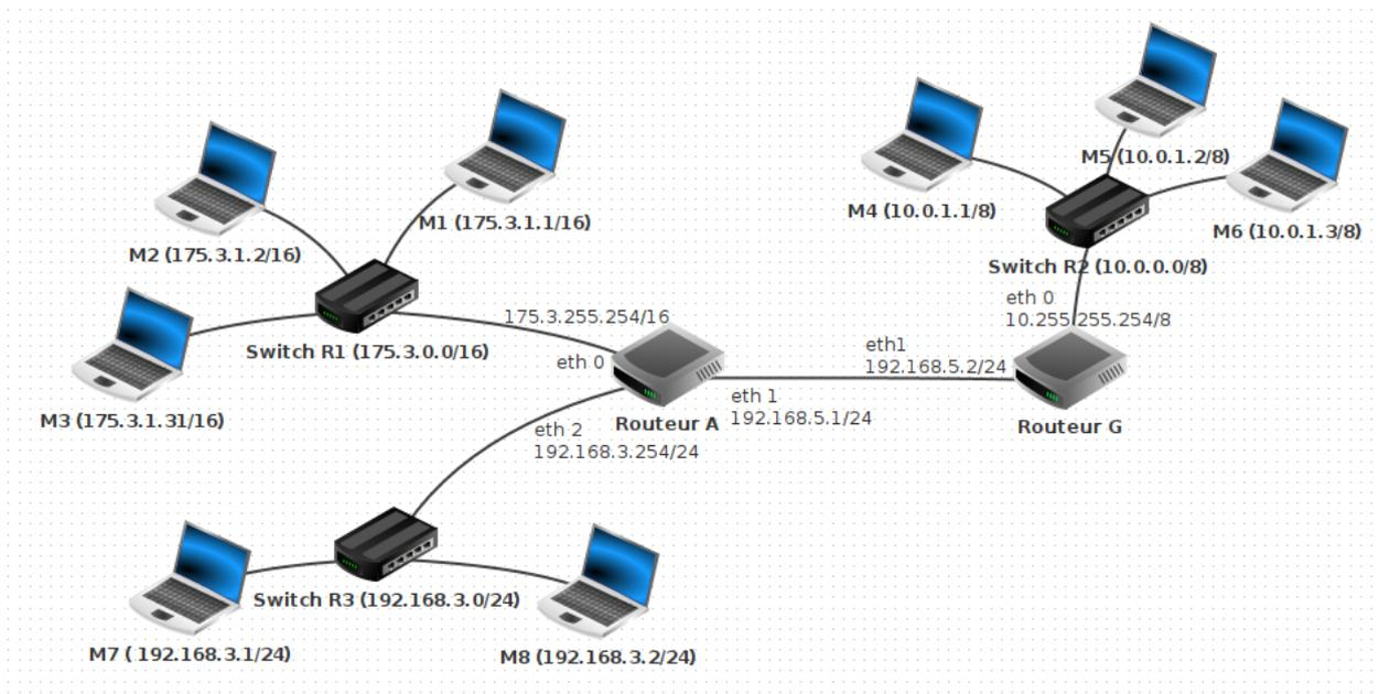
Dans le schéma ci-dessus M1 et M4 n'ont pas la même adresse réseau (car elles n'appartiennent pas au même réseau local), si M1 cherche à entrer en communication avec M4, le switch R1 va constater que M4 n'appartient pas au réseau local (grâce à son adresse IP), R1 va donc envoyer le paquet de données vers le routeur A. Cela sera donc au routeur A de gérer le "problème" : comment atteindre M4?
